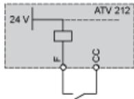
Posición "PLC" con salidas de transistor de PLC
